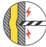
Механическое повреждение изоляции
